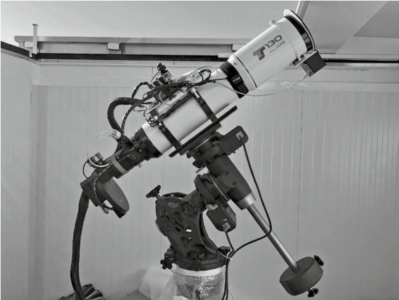
Teleskopet består av en 130 mm APO-refraktor på en Celestron CGE Pro-montering. Kameran är en Moravian G2 med filter för LRGBV Ha OIII SII. Datasystemet är redundanter med två identiska datorer. Mjukvara som kommer användas är främst Maxim DL, Focus Max och ACP. Tre webbkameror gör att vi när som helst kan se teleskopet remote ur olika vinklar. Foto: Claes Martinsson
